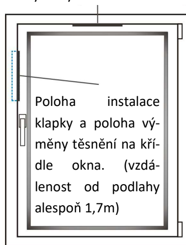
Obr. 1B Varianta montáže se zvýšenou zvukovou izolací
